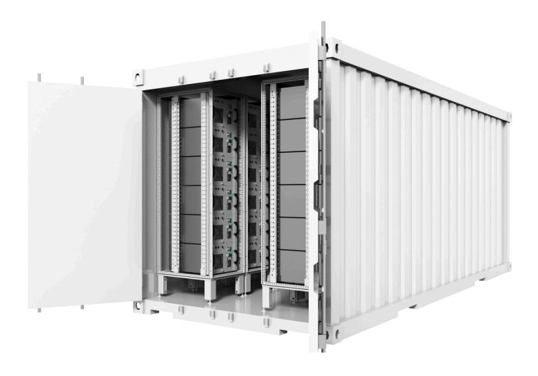
Enapter 的 AEM Cluster 70 是一个完全组装的、可随时运行的、包装在20英尺集装箱内的电解槽系统。它提供纯度为 99.9% 的 36Nm³/hr 的氢气。现场工程仅限于连接通风和净化管道、供水、氢气出口管道以及电网连接。
