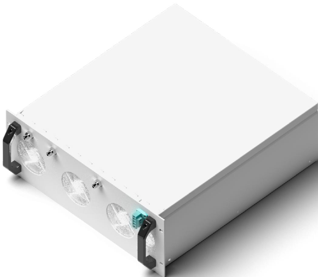
Осушитель Enapter представляет собой гибридную адсорбционную систему, которая состоит из нескольких картриджей, наполненных высокоадсорбирующим материалом. Во время работы часть картриджей улавливает влагу из потока газообразного водорода, тогда как другая часть картриджей нагревается при помощи ТЭН и регенерируется. Осушитель устанавливается в стандартную 19" стойку или шкаф.
