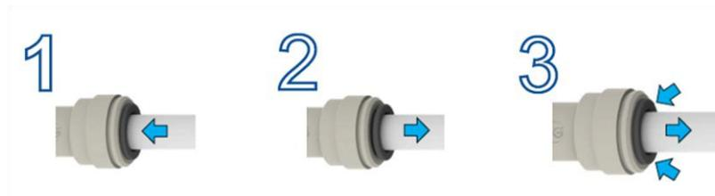
1. Schneiden Sie das Rohr rechtwinklig ab und entfernen Sie scharfe Kanten. Achten Sie darauf, dass der Außendurchmesser frei von Kerbstellen ist und der Schnitt senkrecht über das Rohr verläuft. Führen Sie das Rohr vollständig in den Fitting ein. Der eingesetzte Rohrdurchmesser muss 8 bzw. 10 mm für das automatische Nachfüllen und die Entlüftungsöffnung betragen.
