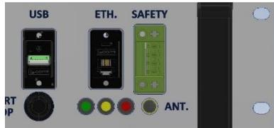
Die drei LEDs, die sich neben dem rechten Griff auf der Frontplatte befinden, dienen zur Anzeige des Systemstatus und des Betriebszustands. Detailliertere Informationen finden Sie in den Cloud-Diensten und in der App Enapter, in der die spezifischen Gerätezustände und Fehler-/Warnmeldungen aufgeführt sind.
