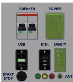
«ETH.» – Порт Ethernet обеспечивает доступ к Modbus TCP. Доступ к карте регистров Modbus можно получить в онлайн руководстве Enapter по адресу <https://handbook.enapter.com>.
