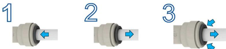
1. Отрежьте трубу и удалите острые края. Убедитесь, что отсутствуют следы от надрезов, а разрез выполнен перпендикулярно трубе. Полностью вставьте трубу в фитинг. Диаметр трубы должен составлять 8 мм для ввода воды. Для кислородной вентиляционной линии вставьте небольшой отрезок 10 мм трубы и установите обратный клапан как можно ближе к выходному порту.
