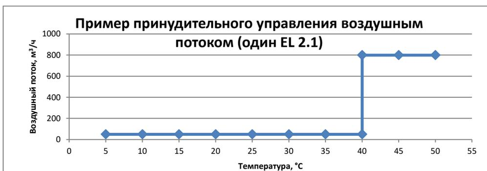
Если принудительная циркуляция воздуха не может быть эффективно реализована, например, при использовании генераторов водорода в особо жарких условиях, можно допустить небольшой или нулевой поток воздуха. Тем не менее, в этом случае необходимо постоянно контролировать уровень водорода в шкафу и отключать питание в случае обнаружения утечек.
